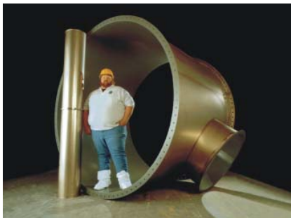
图3. 含氟聚合物涂层PSP的大小管道的例子。
