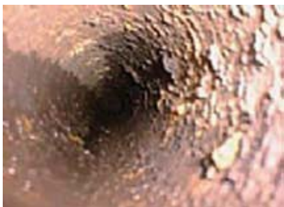
图4 配管长期使用后，附着厚厚的水垢。 科技节能机有许多优势，如附表。
