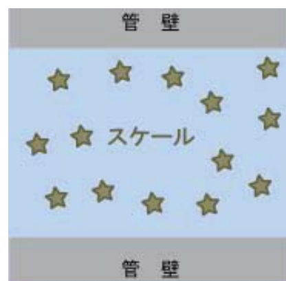
图1 配管内的水垢状况(初期)。以金属离子 ( \text{Mg}^{2+} 、 \text{Ca}^{2+} )、硅酸等作为核心。
