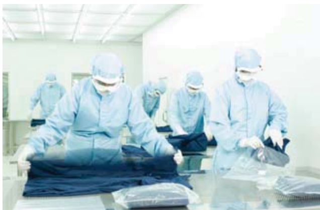
图 1. 在 ISO5 级洁净室洗衣房内，对可重复使用的服装进行包装。
