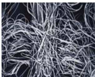
图 3. 无纺聚酯/纤维混纺织物。
