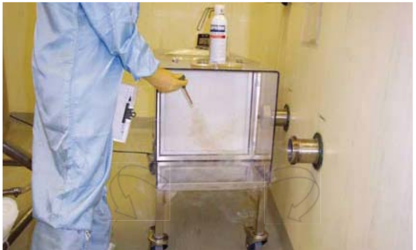
图 3. 照片显示，有快速流动的水平强气流穿过单向气流单元的表面和出气口。因此活动或操作所引起的任何污染都不太可能继续留在附近。
