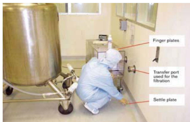
图 2. 照片显示过滤室中的过滤工作布置 (无菌灌装房)。
