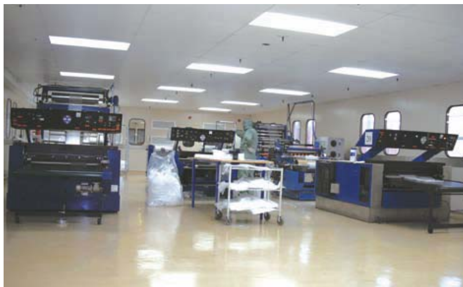
该公司开发出一种能够使用个位数微粒计数器生产包装袋工艺，不再需要以千计为单位的微粒计数器来完成这项工作。
