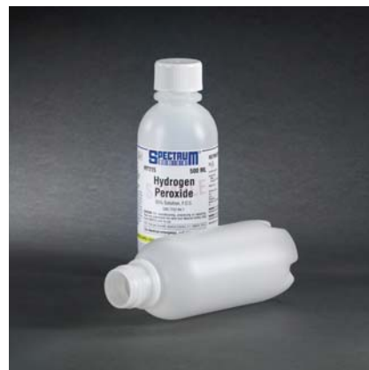
图 1. 500mL “子弹形”超洁净 HDPE 瓶子，它使用过滤后的氮气吹塑成形，然后密封以保证洁净度，使之满足对微粒敏感的化学药品和工艺的要求。这种瓶子具有耐压性，可以承受比较高的压力。图片来源：Novapak 公司
