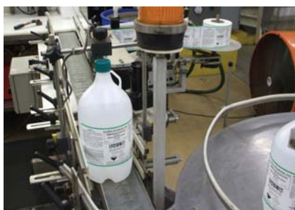
图2. 使用经过严格过滤的氮气对4L耐压超洁净瓶子进行吹塑成型和泄漏测试。 图片来源: Novapak 公司
