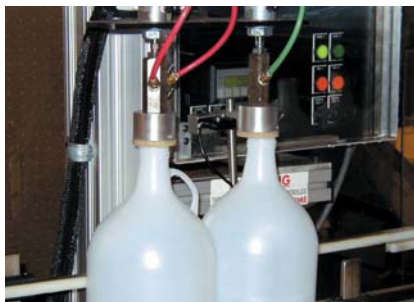
图2. 使用经过严格过滤的氮气对4L耐压超洁净瓶子进行吹塑成型和泄漏测试。 图片来源: Novapak 公司
