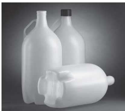
图4. 4L 耐压超洁净瓶子采用同心圆设计,可以防止瓶子在压力下变形,而且可以稳定地、安全地运输氢氧化铵这类高蒸汽压力的超洁净化学药品。图片来源: Novapak 公司
