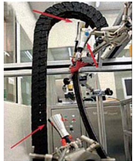
图 1. 在三个红箭头指示的不同电缆处分别放置光学微粒计数器 (0.1-5.0μm)，对运行速度不同的电缆做 100 分钟的记录。
