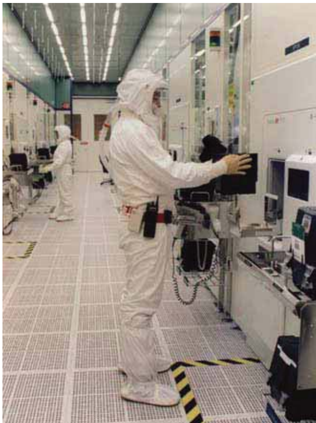
英特尔技术人员通过 Fab，利用自动化测量工具监控晶圆的加工处理。 图片由 Intel 授权
