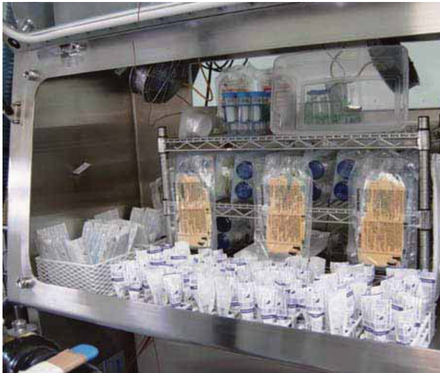
将二氧化氮发生器连接到一个满载的 three-glove Transfer Isolator 进行测试。
