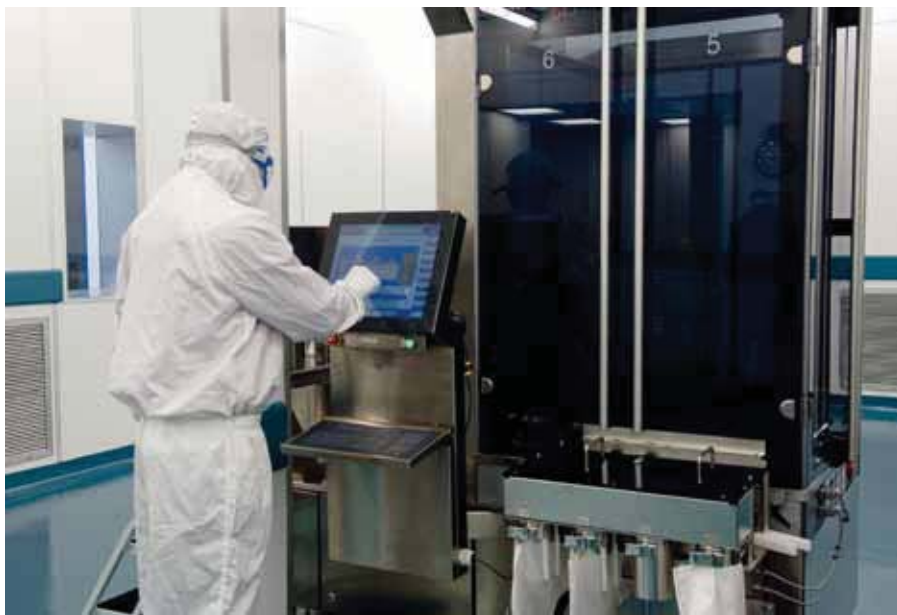
Envision 可视检测工艺可以自动检测合成橡胶部件，识别质量不合格的产品。
