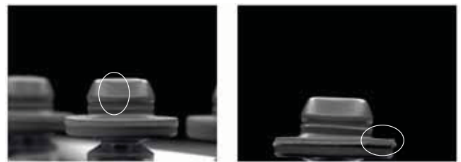
图 3. 橡胶塞成型及修剪缺陷。
