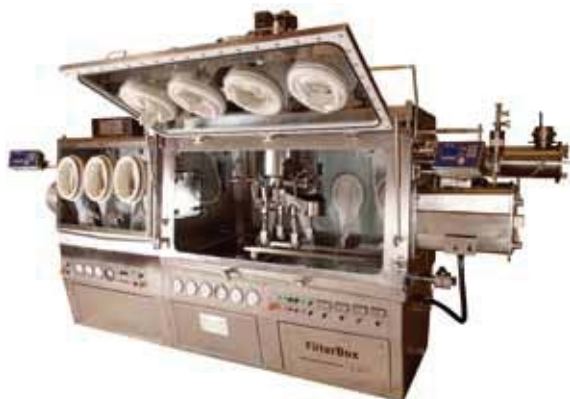
图 3. PSL FilterBox——设置了压力过滤烘干机。
