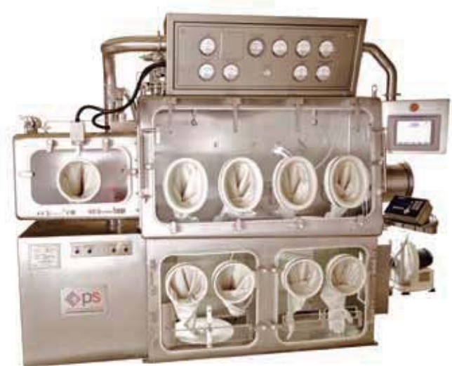
图 1. 全封闭的高密封隔离器具有上下腔室用于配药和取样作业。
