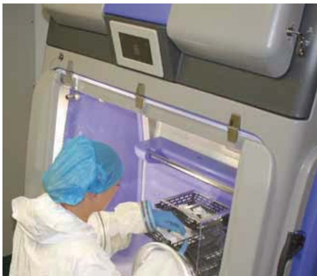
图 3. 封闭屏障工作站将自动化过氧化氢蒸汽生物净化技术纳入到模块化隔离器系统中——Bioquell QUBE。
