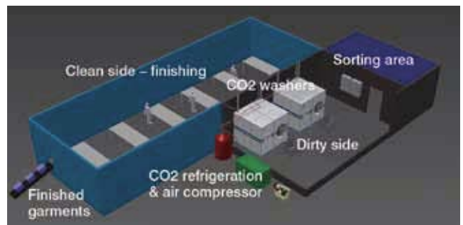
图 3. 典型的二氧化碳基工厂（不按比例）。二氧化碳基洗衣的特点是占地面积小 / 基础设施最小；没有供水 / 排水管网系统及相关收费和许可证；更低的能源成本 / 更低的维护成本；20-25min 循环周期（干到干） / 所有废弃物当场收集。
