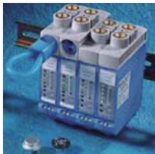
图 1. Ashcroft DXLdp 采用导轨安装设计，以确保占用空间小，当进行校准（最左边的单元）时，通过一个短管就可以实现高低压端口之间真正的零压差。Si-Glas 传感器是 DXLdp 的基石。
