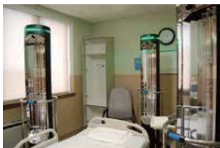
Surfacide Helios 系统使用三个独立发射器，利用紫外 (UV-C) 光能量进行表面消毒。
