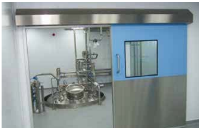
图 2. WHP 客户 Rosemont Pharmaceuticals。其任务是，在 cGMP 的环境中，结合微粉化的活性药物成分，设计并建造口服液和悬浮液制造单元。处理要求主要关注的是，在一个 cGMP 的环境中，有效地处理精细粉末和液体，有能力生成均匀溶液、悬浮液和混合物。
