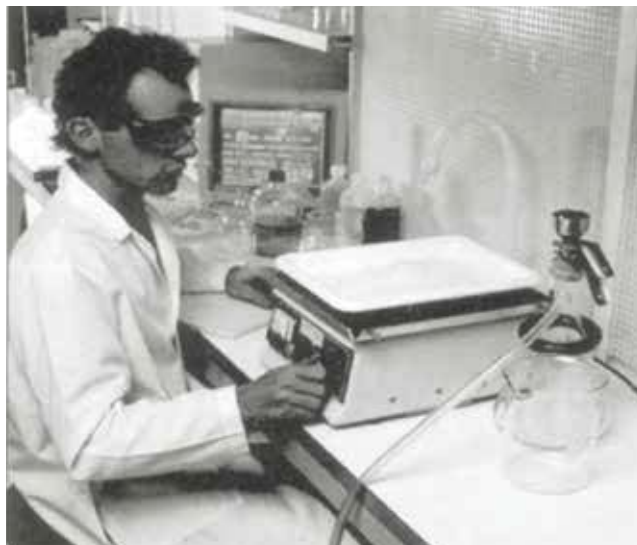
颗粒计数测试中用于样品准备的实验定轨振荡器
