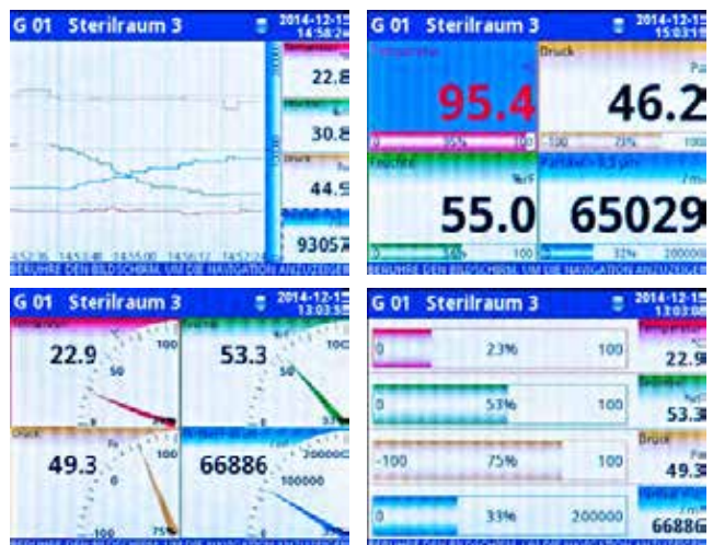
图2. 始终保持测量数据清晰地显示在视野内——PUC 44 的触摸屏可以同时显示4个画面。
