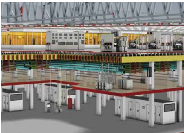
图 1. “2+1” 晶圆厂房截面原理图。
