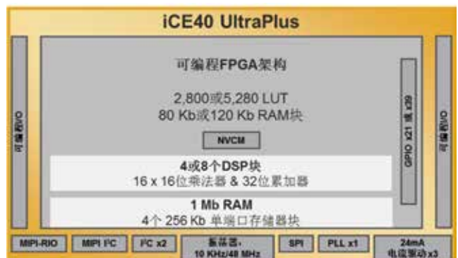
莱迪思 iCE40 UltraPlus FPGA 框图。
