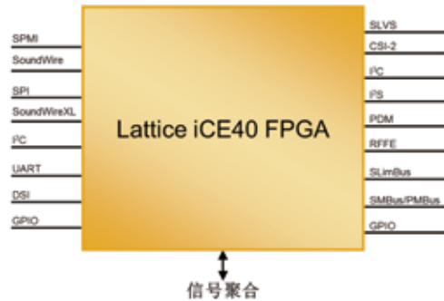
莱迪思 iCE40 FPGA 为信号聚合和快速布局调整提供了灵活的 I/O 中心。
