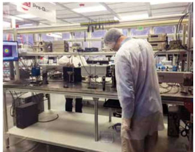
图 2：用于产生 EUV 光的 \text{CO}_2 激光器，正在一座现代化制造工厂中接受严格测试。
