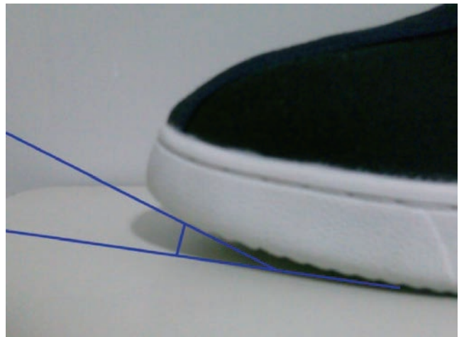
图 2 鞋头翘起设计示意图
