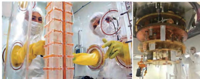
左图：CUORE0 在意大利格兰萨索国家地下实验室洁净室中组装； 右图：CUORE 合作组设计建造的世界上最大温度最低的低温器。
