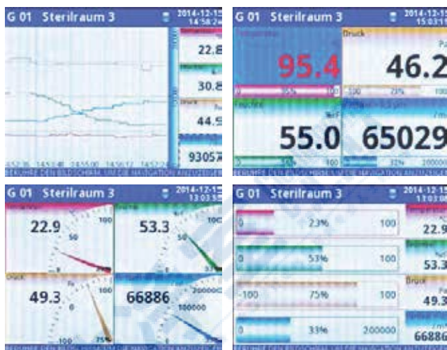
图 2. 始终保持测量数据清晰地显示在视野内——PUC 44 的触控屏可以同时显示 4 个画面。
